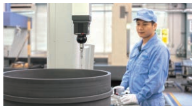
使用 3D 测量机制进行检查
