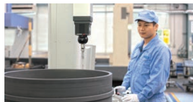
使用 3D 測量機器檢查
