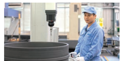
Pemeriksaan menggunakan mesin pengukur 3D
