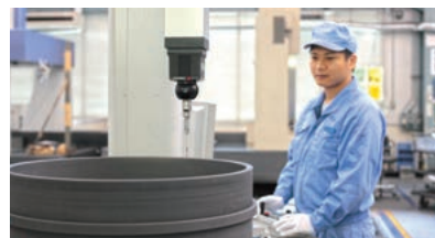
Ispezione utilizzando una macchina per la misurazione 3D
