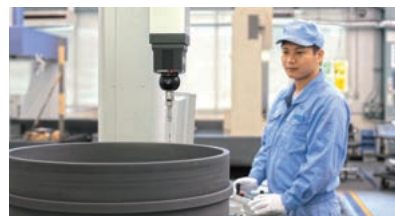
Inspección mediante el uso de una máquina de medición 3D
