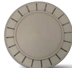
Ejemplo de TaC (carburo de tantalio) que recubre el grafito y una foto de secciones transversales
