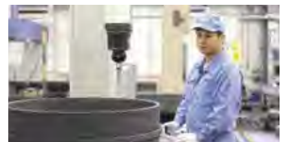
การตรวจสอบด้วยเครื่องวัดแบบ 3 มิติ
