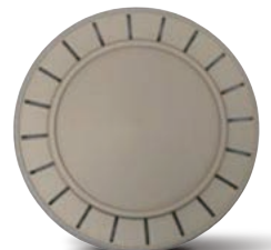
ตัวอย่างของกราไฟท์เคลือบ TaC (แทนทาลัมคาร์ไบด์) และภาพ ตัดขวาง
