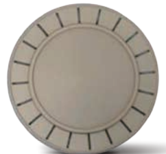
ตัวอย่างของกราไฟท์เคลือบ TaC (แทนทาลัมคาร์ไบด์) และภาพ ตัดขวาง
